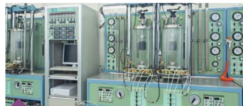
3 小型三軸圧縮試験 (φ50mm、φ70mm、φ100mm)
