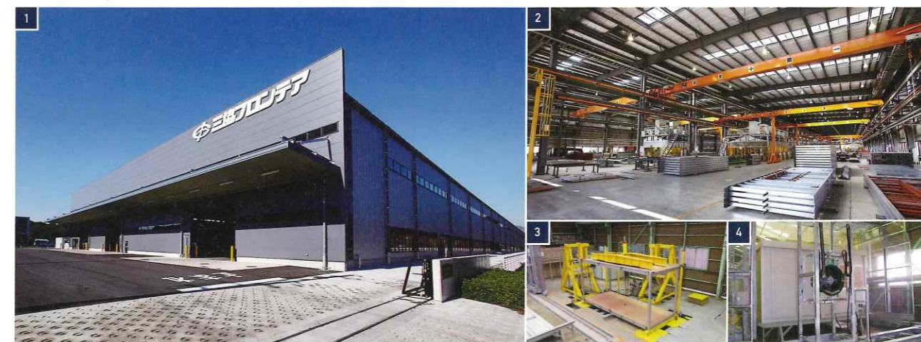
1. 210mのラインを有するつくば工場 3. 4. 実大サイズの強度試験機や最大風速30m/秒を再現する暴風雨水密試験機も自社開発
